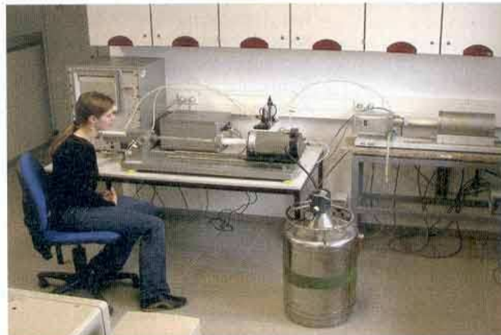
Frostdilatometer und Dilatometer zur Bestimmung der Längenänderung von Probekörpern Frost dilatometer and dilatometer to determine the change of length on specimens
