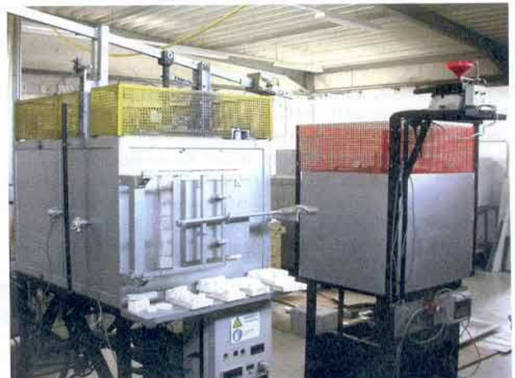
Anlagen zur Bestimmung von Heißbiegefestigkeit und Heißabrieb Equipment to determine the hot bending strength and hot abrasion
